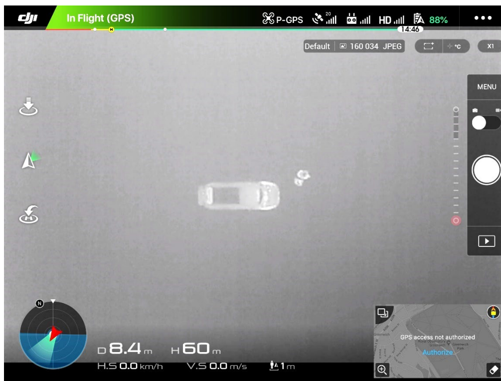
Figur 9. För att utesluta att flygning i disigt väder ger sämre värmesignatur utfördes en test. Resultatet är att våra egna värmesignaturer på 60 m syns klart och tydligt vilket betyder att vi även kan se viltets värmesignaturer.
